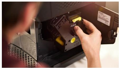
Блокът за приготвяне е сърцето на всяка напълно автоматична кафемашини и трябва да бъде почистван редовно. Подвижният блок за приготвяне ви позволява да го почиствате изцяло само чрез изплакване под течеща вода.
